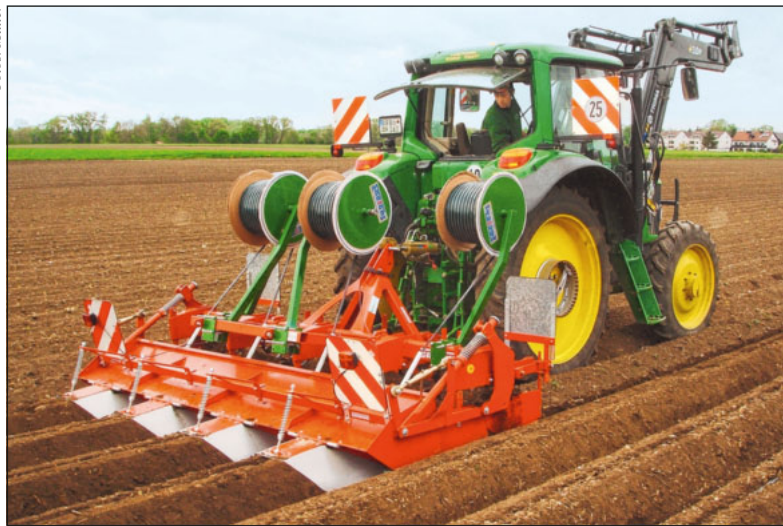
Die hier verlegten Schläuche befeuchten die Dämme von der Krone aus (Dammkronenverfahren). Ausgehend von der Tropfstelle durchnässt der Boden in Form einer von der Bodenart abhängigen Kuppelform (Bild rechts).
