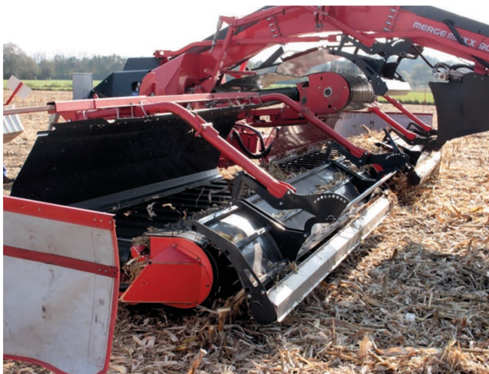
Abb. 4: Bandschwader MergeMaxx 902 mit hochgeklapptem Mittelteil zur mittigen Schwadablage
