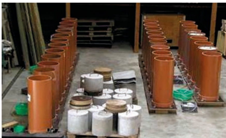
Abb. 1: Versuchsbehälter mit Gewichten zur Simulation der auftretenden Drücke
