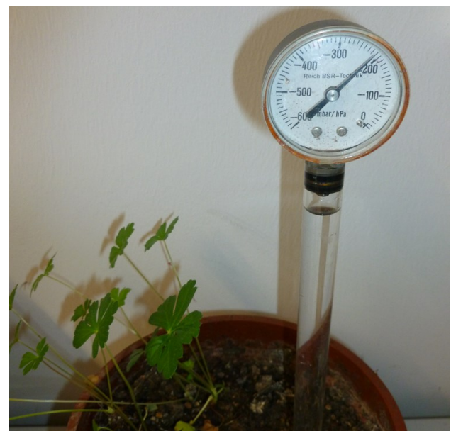
Bild 2: Die Wasserverfügbarkeit im Boden ist ausschlaggebend für den Bewässerungsbedarf. Die Saugspannung kann z.B. mit einem Tensiometer bestimmt werden.
