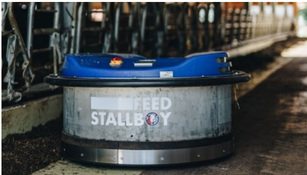
Abb. 15: Anschieberoboter (Betrieb Eichler)
