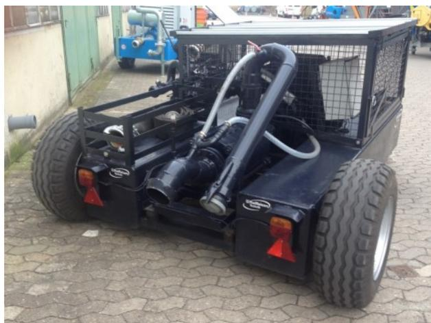
**Bild 2:** Auch Beregnungsaggregate sind land- oder forstwirtschaftlich angehängte Arbeitsgeräte und sind mit entsprechender Beleuchtung und Kenntlichmachung auszurüsten. Ein Wiederholungskennzeichen und ein Geschwindigkeitsschild sind empfehlenswert.
