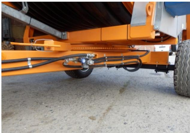
Bei einer Beregnungsmaschine erhöht sich die Achslast aufgrund des Wassergewichtes im Trommelschlauch und das kann dann eine Bremse erforderlich machen. Übrigens: Beregnungsmaschinen die eine EU-Typgenehmigung haben, benötigen eine Bremse ab einem zulässigen Gesamtgewicht von 3,5 t.
