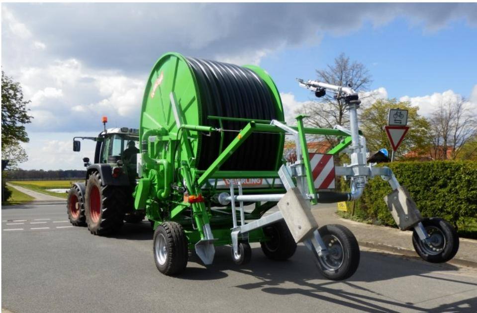
**Bild 1:** Der aufgesattelte Regner ragt mehr als 1000 mm über die Beleuchtung der Beregnungstrommel hinaus. Die Warntafel ist dann vorgeschrieben. Bei Dunkelheit müsste zusätzlich eine rote Rückleuchte und ein Rückstrahler angebracht sein.
